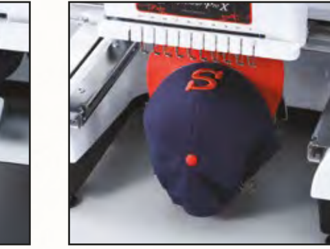
Geniş Şapka Kasnağı PRPCF1 (360x60mm) Standart Şapka Kasnağı PRCF3 (130x60mm)
